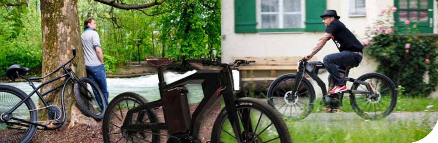
Komplett aus Kohlefaser wiegt das bis zu 100 Stundenkilometer schnelle Blacktrail keine 20 Kilo.
